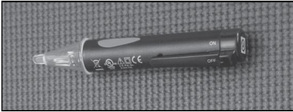
Figure 2 - Utiliser un détecteur de tension sans contact pour s'assurer que l'alimentation est coupée avant toute intervention sur un circuit.
